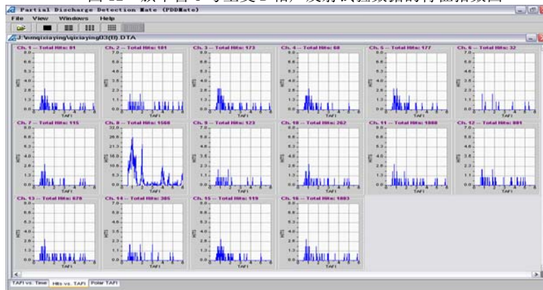
图 13 旗下营 3 号主变 B 相声发射试验数据的撞击图谱
